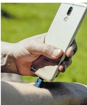
Der Hitzestick von heat\_it wird durch den Strom aus dem Smartphone rund 50 Grad heiß.
